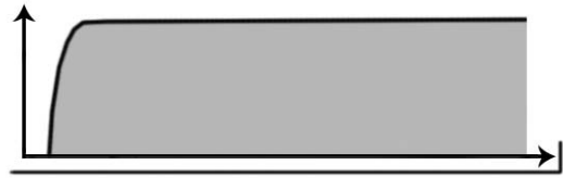
Figura 19.2. Esquema de una corriente galvánica. La intensidad de la corriente sube de manera progresiva cuando se abre el circuito, y se mantiene por todo el tiempo, hasta que se cierra el circuito.
