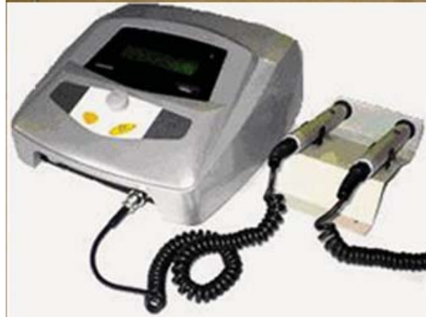
Figura 30.20. Equipos desarrollados por empresas cubanas. a) Equipo FISSER 21, desarrollado por el CEADEN. b) Equipo Lasermed 670, de la empresa TECE SA. En ambos casos, cumplen con todos los parámetros requeridos para la terapia, además, permiten la conexión de diferentes sondas, cada una con diferentes longitudes de onda.
