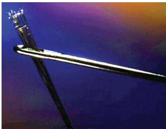
Figura 30.17. Fragmento de fibra óptica que puede pasar cómodamente por el agujero de una aguja. A través de diferentes tipos y diámetros de fibras ópticas, la luz láser se puede llevar a las cavidades más recónditas del organismo.
